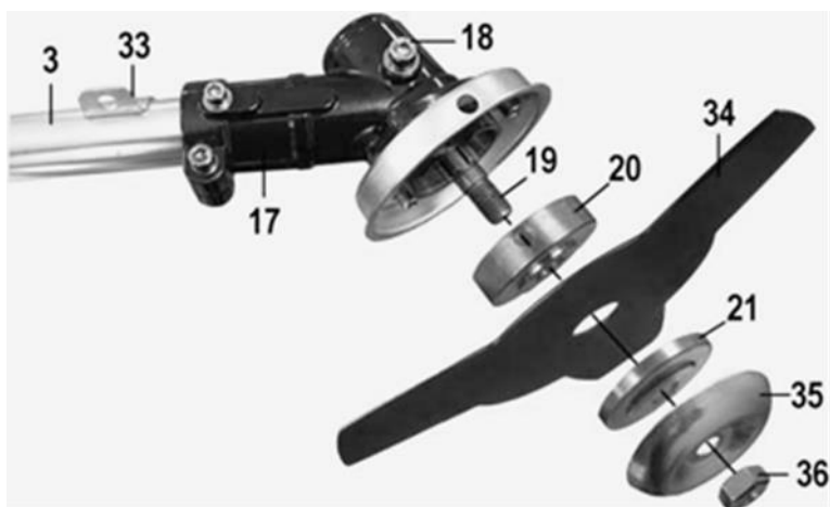
Рис. 3 Порядок установки на триммер ножа (диска)
